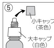
溶解液容器の白色の大キャップをとりはずす。その際、瓶口部に溶解液の膜が張っている場合は、膜が無くなるまで、瓶の脇部を軽く押える。
